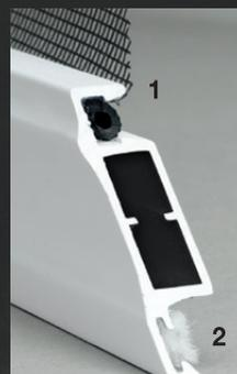
Exclusive à Caron et Guay, la nouvelle moustiquaire ultrarobuste, fabriquée entièrement d'extrusion d'aluminium (1), offre une rigidité supérieure à la norme de l'industrie, faisant de celle-ci l'une des plus durables et faciles d'entretien offertes sur le marché. Le tout nouveau système d'étanchéité Schlegel (2), aussi exclusif à Caron et Guay, rend le pourtour de la moustiquaire complètement hermétique, ce qui ne laisse aucune chance aux insectes, option A, de pénétrer dans votre demeure.
